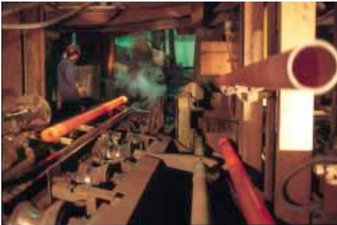
**Das im Schleuderguss-Verfahren hergestellte Rohr wird aus der Kokille gezogen**
