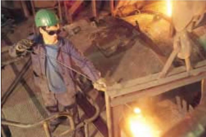
**Gussbruch, Eisenschrott und Zuschläge werden im Heißwind-Kupolofen eingeschmolzen**
