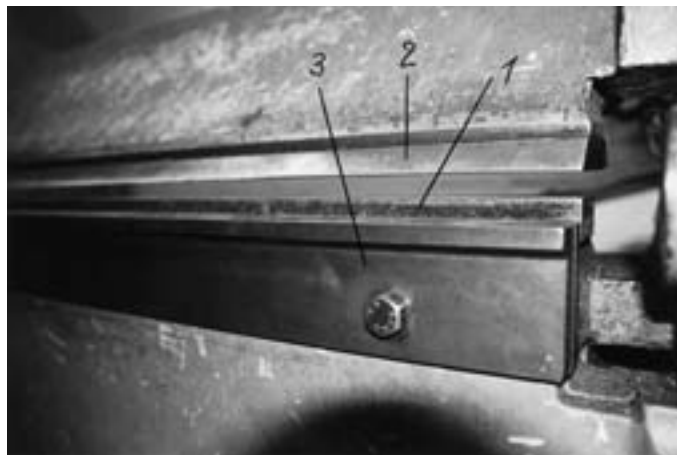
Unterwanne (1) und Oberwanne (2) der Abkantbank fixieren das Blech, mit der Biegewanne (3) wird die Kantung hergestellt
