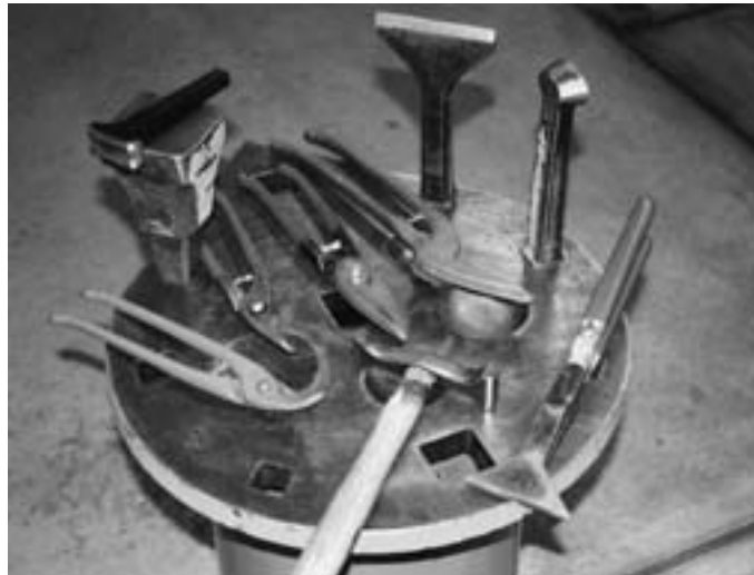
Kleine Blechwerkzeugkunde (v. l.): Rundlochscherer, Stiftamboss mit Falzmeißel, Lochschere, gerade Schere, Durchlaufschere, Umschlageisen, Bördeleisen, Quetschfalzzange, Schweißhammer
