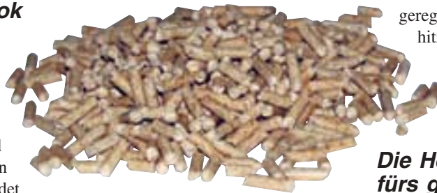
... heute bestehen die Pellets aus Holz-Abfallprodukten und müssen strenge Qualitätsanforderungen erfüllen
