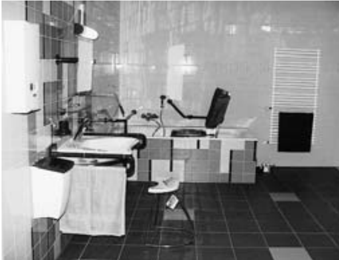
Ein Waschtisch, vor dem man sitzen kann, Wannelift und bodengleiche Dusche sind einige Merkmale des „besonderen“ Bades
