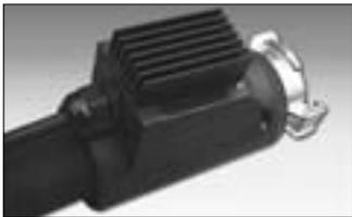
Reglerplatine untergebracht. Der flexible Heizleiter liegt einvulkanisiert im Kern des Schlauches. Schutzklasse ist IP 64, der Biegeradius beträgt 250 mm. Lediglich am Anschlusskopf wird elektrische Energie mittels Kabel zugeführt. Hier ist auch der Temperatursensor integriert, sodass die Temperatur über den Gefrierpunkt gehalten oder das Wasser bis maximal 60 °C geheizt wird. Die beheizten Wasserzuleitungen gibt es in Standardlängen von 10, 20 und 40 m bei einer Größe von DN 20.
