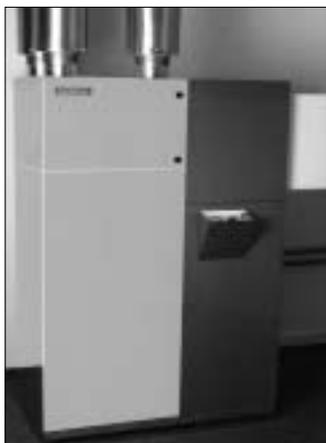
Nach Angaben von Siemens-Novelan eignet es sich mit einer Heizleistung von 7,3 kW vor allem für Niedrigenergiehäuser mit Wohnflächen von bis zu 180 m<sup>2</sup>. Das WP-Modul wird mit einem FCKW-freien Arbeitsmittel betrieben. Bereits integriert sind Warmwasser- und Pufferspeicher, Umwälzpumpe, Überstromventil und Elektroheizstab. Das eingliederte Be- und Entlüftungsmodul gewinnt über einen Gegenstrom-Wärmetauscher Wärme zurück und ermöglicht so einen Wirkungsgrad von bis zu 90 Prozent.
