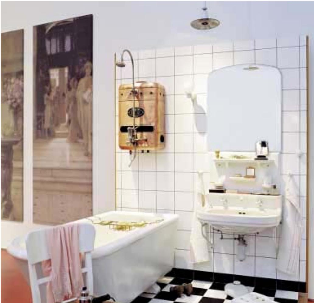
*Um eine glatte Oberfläche zu erzielen, erhielt der schamotteartige, wasserdichte Scherben eine dauerhafte Glasur. Feuerton ist an den feinen Haarrissen in der Glasur erkennbar. Bedingt durch die hohen Brenntemperaturen, setzt das Material dickwandige Formen voraus. Diese Badewanne bringt es somit auf eine Masse von nahezu 900 kg. Einmal richtig vorgeheizt, hält sie die Wassertemperatur über lange Zeit konstant.*
