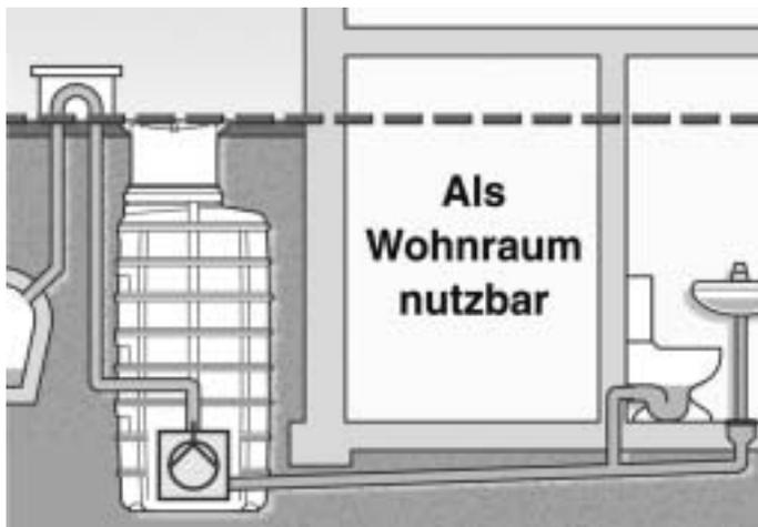
verlagern. Der Schacht aus Polyethylen ist als Baukastensystem gefertigt. Die Grundversion umfasst mehrere Gerinnevarianten, sowohl offene, als auch geschlossene Gerinne. Als Rückstauschutz können die Rückstauverschlüsse Staufix SWA, Staufix FKA oder
