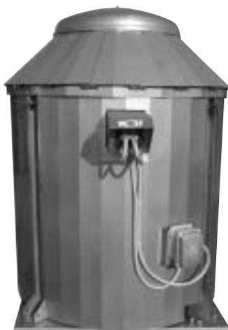
ten, rückwärtsgekrümmten Kreisbogenschaukeln. Der Drehstrommotor sitzt isoliert außerhalb der Brandgase. Die Silikonkabel sind mit Metallummantelungen versehen und werden über Kühlluftstutzen nach außen geführt. Als Zubehör wird eine selbsttätige, sowohl saug- als auch druckseitig funktionierende Verschlusskappe aus Stahlblech, Edelstahlblech oder Aluminium angeboten.
