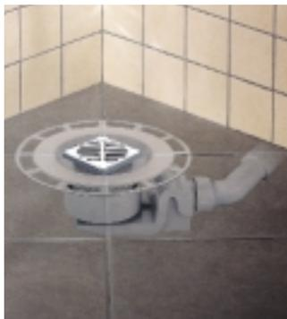
Duschen werden in einem solchen Installationsumfeld in der Regel mit Flüssigfolien auf dem Estrich abgedichtet. Hier überzeugt – so Viega – der Duschablauf durch ein „Sicherheitsdoppel“, bestehend aus einem mit einem Spezialvlies beschichteten Abdichtflansch sowie einer zusätzlichen Gewebemanschette.
