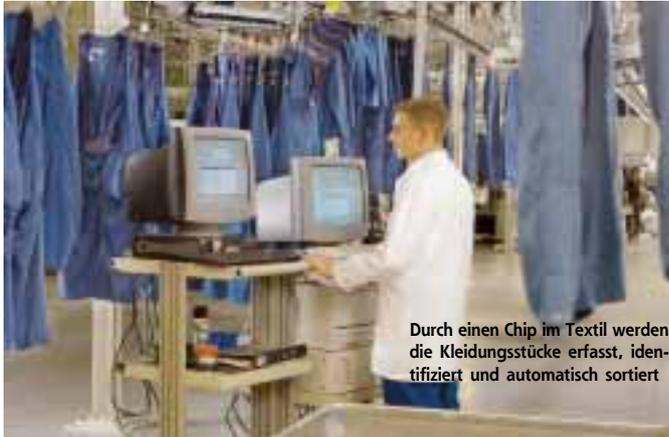
Durch einen Chip im Textil werden die Kleidungsstücke erfasst, identifiziert und automatisch sortiert
