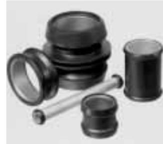
Außenfläche gummiert und verfügen an den Enden über gummierte umlaufende Dichtwulste. Plug & Seal ist somit Rohrzwischenstück, Dichtung und Anschlagdämpfer in einem einzigen Bauteil. Die Simrit Plug & Seal Rohrstücke können aus Stahl, Aluminium oder Kunststoff gefertigt werden. Für die Gummierung, die Dichtwulste und die Anschlagdämpfung stehen Elastomere zur Verfügung.
