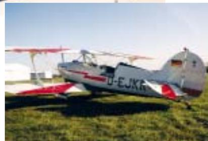
Die Skybolt RE III ist 5,99 m lang, 2,13 m hoch und hat eine maximale Spannweite von 7,32 m
