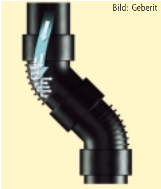
Formstücke mit "eingebauten" Schwingungsdämpfern verhindern, dass die Rohrwandung in Wallung gerät
