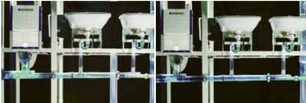
Doppelfehler: Der 88,5°-Abweig am WC lässt gut die Hälfte des Spülwassers in die Anschlussleitung der anderen Objekte drücken; Rückspülungen werden durch die sohlengleichen Red-Stücke nicht verhindert
