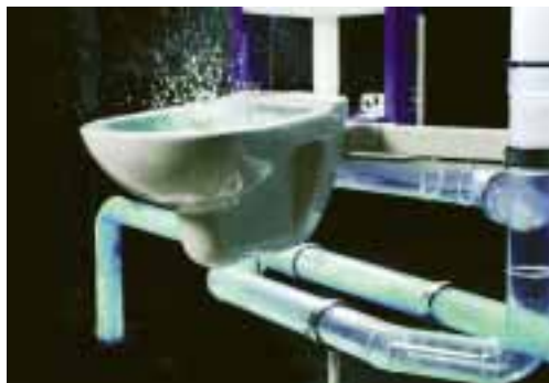
Werden Sanitärobjekte im Überdruckbereich einer Fallleitung angeschlossen, hat man einen Springbrunnen gebaut
