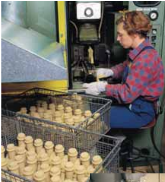
Der Kern aus einem Quarzsand-, Härter-, Binder-Gemisch wird in einer Form unter Druck hergestellt
