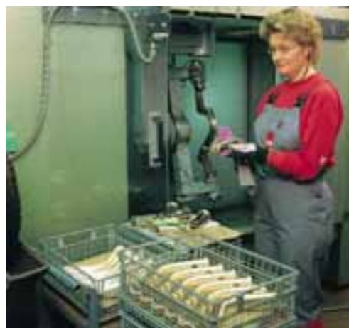
Vor dem Galvanisierungsprozess werden die Armaturen poliert, um letzte Unebenheiten zu entfernen und die Basis für eine einwandfreie Oberfläche zu schaffen
