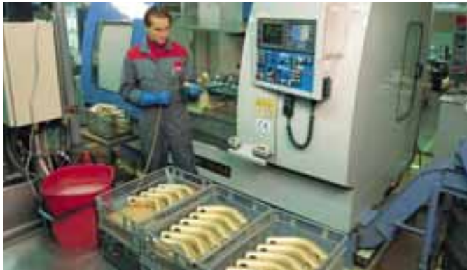
In einem CNC-gesteuerten Bearbeitungszentrum werden die Bohrungen und Gewinde eingebracht
