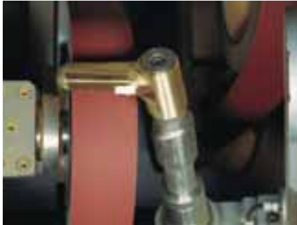
... dabei wird der Armaturenrohling nach einem programmierten Ablauf an der Schleifscheibe bearbeitet
