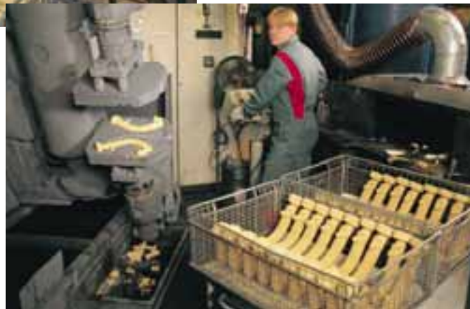
Die Kerne werden in die Kokille des Gießautomaten eingelegt und mit Messing unter Druck umgossen
