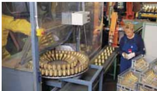
Im Schleifzentrum werden die Rohlinge mit einem Greifarm aufgenommen und den verschiedenen Schleifscheiben zugeführt . . .
