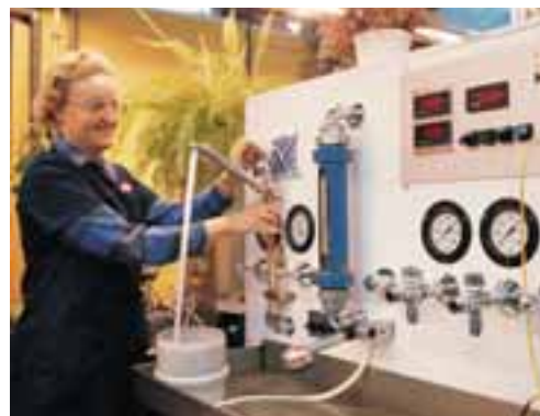
Nach Montage des Innenlebens wird jede Armatur auf Dichtheit und Funktion geprüft
