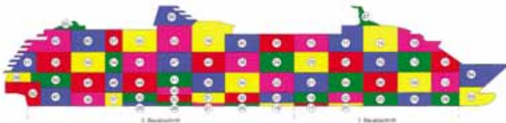
Ein Blockplan regelt den Zusammenbau der einzelnen Blocks
