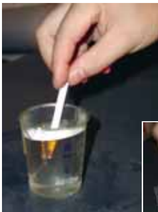
Die pH-Wert-Messung ist beim Heizungswasser-Check besonders wichtig
