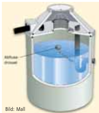
Speicher mit Abflussdrossel: Erst wenn der Wasserstand so hoch steigt, dass der schwimmende Ablauf unter Wasser gezogen wird, bekommt der Kanal Arbeit
