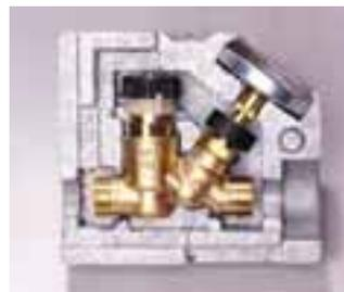
Anwender sei somit die Planungs- und Betriebssicherheit für Trinkwasserzirkulationssysteme nach DVGW W 553 gewährleistet. Die Zirkulationsventile sind in Rotguss ausgeführt und werden als Einheit von Ventil, Thermometer und Isolierung geliefert. Die Funktionselemente sind auf einer Seite angeordnet. Lieferbar sind die Nennweiten DN 15 bis DN 25 mit Muffen- und Außengewindeanschluss.
