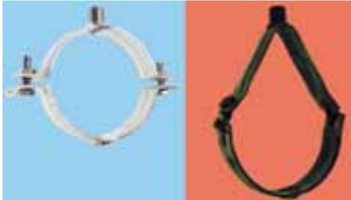
**Ergebnis des Brandversuches einer Stabil D-3G: Sie hält ... aber unter Last- und Temperatureinwirkung wird aus der Schelle eine „Birne“**
