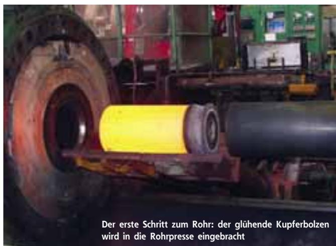
Der erste Schritt zum Rohr: der glühende Kupferbolzen wird in die Rohrpresse eingebracht
