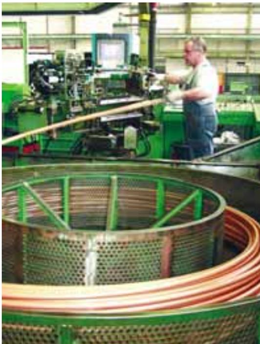
Auf Trommelziehmaschinen werden die Rohre in die gewünschte Endabmessung gezogen
