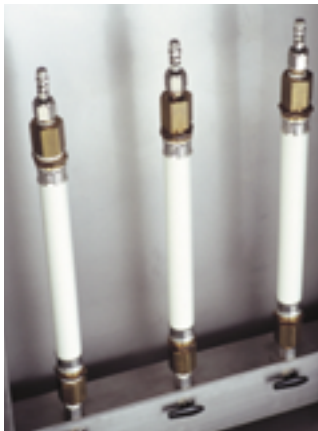
Mit bis zu 200 bar werden bei Hewing die Rohre abgedrückt
