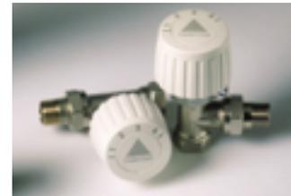
und einem Ventilgehäuse. Er erfasst die Rücklauf temperatur und hält diese durch Rücklaufdrosselung konstant auf Werte, die zwischen 20 °C und 30 °C eingestellt werden können. Er eignet sich überall dort, wo die zu beheizende Fußbodenfläche nicht mehr als 10 m<sup>2</sup> beträgt. Sein Einsatzgebiet ist somit z. B. das Badezimmer, in dem neben dem Heizkörper eine Fußbodenheizung für Wohlbefinden sorgen soll.
