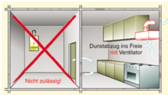
Geräte, die Luft absaugen, stehlen der Feuerstätte die Luft und behindern die Abgasabführung
