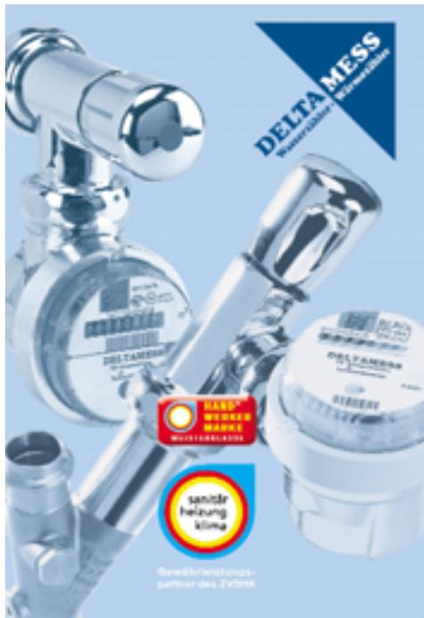
**Zum Titelbild:** Die Ventilwasserzähler von Deltamess lassen sich ohne die Wand aufzustemmen in das Leitungssystem integrieren. Hierzu wird von den vorhandenen UP-Ventilen das Oberteil entfernt und stattdessen ein Ventilwasserzähler, mit eingebauter Absperrung, installiert.
