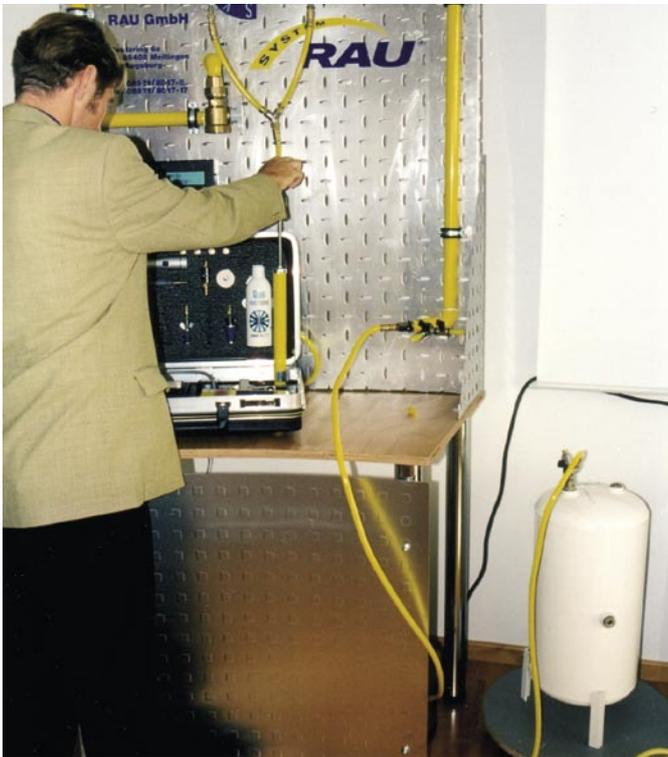
**Ein Versuch zeigt es eindrucksvoll: Bei einer undichten Gasleitung mit nur einem Liter Inhalt zeigt sich sofort ein Druckabfall. Wird ein Volumen von 30 Liter dazugeschaltet (Behälter unten rechts), bleibt der Prüfdruck minutenlang unverändert**
