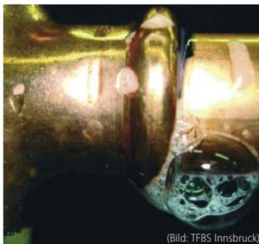
Werden zur Schlussprüfung schaum-bildende Mittel eingesetzt, signalisiert eine Blasenbildung das Leck
