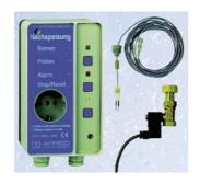
elementen, einem Magnetventil (1/2 x 3/4) und einer Sonde. Zudem verfügt es über eine Sicherheitsabschaltung, die auf mögliche Leckagen im Regenwasserbehälter oder in den Zuleitungen anspricht. Rena wird mit 230 Volt Wechselspannung versorgt und ist für Umgebungstemperaturen von 0 °C bis 40 °C geeignet. Afriso
