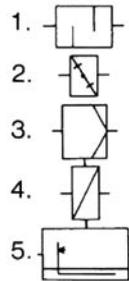
7. Welche Abbildung stellt das nach DIN 1946 genormte Sinnbild für eine Jalousieklappe dar?
