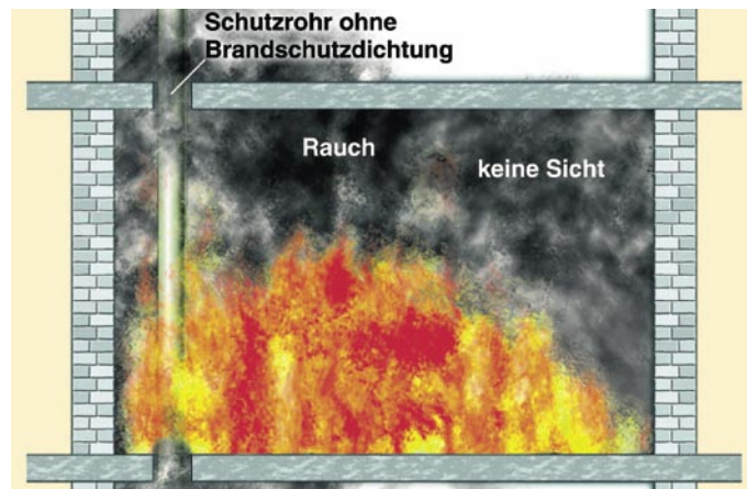
Fehlen fachgerechte Brandschutzdurchführungen, kriecht erst der Rauch, später auch das Feuer, an den Rohrleitungen entlang
