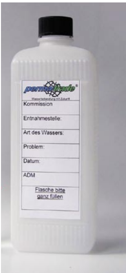
Wasserproben dürfen nur in PE-Probeflaschen oder gut ausgespülten Glas-Mineralwasserflaschen genommen werden
