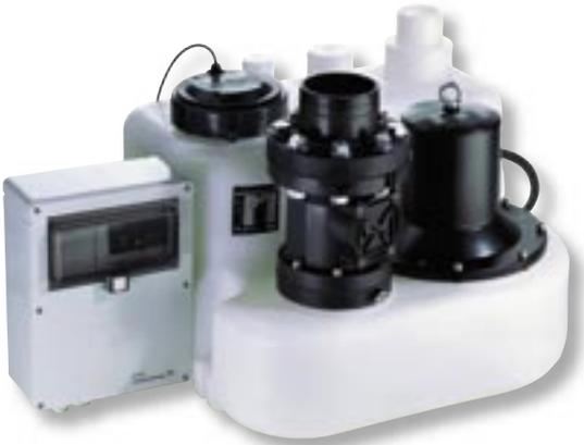
Das Aggregat ist anschlussfertig vormontiert, inklusive Rückschlagklappe und vollelektronischer Steuerung. Sie verfügt über einen Staudruckniveausensor mit getrenntem Niveauschalter für jede Zulaufhöhe und Hochwasseralarm. Zur Ausstattung gehören weiterhin eine Behälterniveauanzeige, die Anzeige differenzierter Betriebs- und Störmeldungen und eine eingebaute Alarmierung. Ferner ist eine Probelauffunktion zur Vorbeugung von Störungen bei selten frequentierten Objekten vorhanden.
