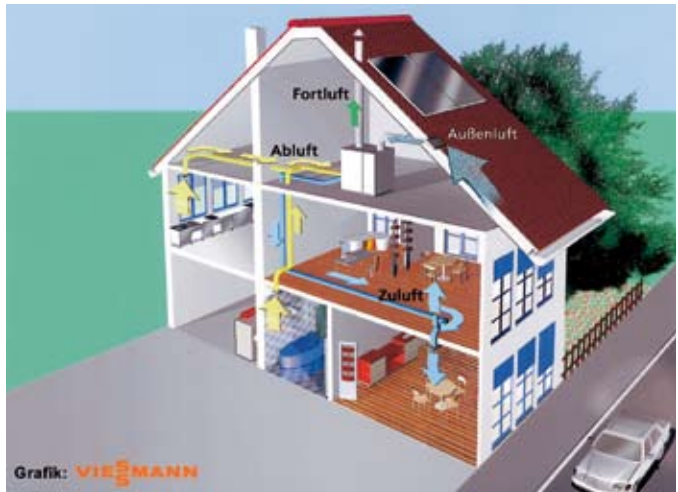
Die Lüftungsanlage besteht im Wesentlichen aus Zu- und Abluftleitungen, Wärmetauscher und Filter
