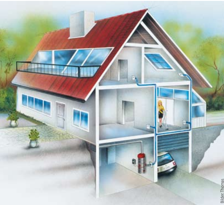
Rohrsystem, Saugereinheit und Abluftabführung machen das Saugen leicht und hygienisch
