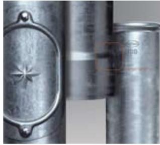
erfolgt in verzinktem Stahl mit Innenbeschichtung; wahlweise mit oder ohne Reinigungsöffnung. Letztere mit geschlossenem oder geschlitztem Reinigungsdeckel. Die Standrohre sind mit Größenangabe und Herstellerstempelung versehen.
