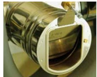
net. Eine aufgespritzte EPDM-Dichtlippe soll für einen geräuscharmen Betrieb sorgen und den Austrag von Flugasche bzw. Staub verhindern. Der Zugbegrenzer aus Edelstahl reduziert die Abgasemissionen durch einen gleichmäßigen Abbrand, verringert die Verschmutzung der Anlage und spart damit Brennstoff und Geld. Je nach Nutzungsgrad und Unterdruck sei laut Hersteller eine Einsparung von bis zu 9 % möglich. Das nachrüstbare Bauteil lässt sich auch mit einer Motorsteuerung bestücken.
