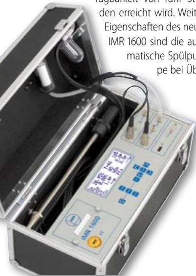
schreitung des CO-Messbereichs, spezielle Akkus, ein vierzeiliges LCD-Display zur Anzeige von bis zu acht Messwerten sowie ein Thermodrucker.
