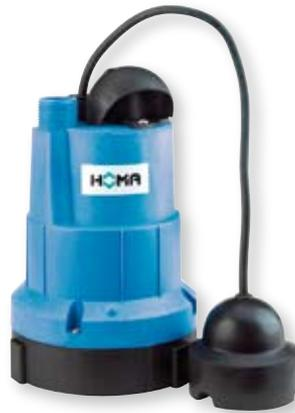
des Ausdehnungswassers mit Pumpe und Eimer sichergestellt werden. Die Schaltung der Pumpe erfolgt über einen Sensorschalter. Sie fördert bis zu 6000 Liter verschmutztes Wasser in einer Stunde. Durch den Kühlmantel fließt das gepumpte Wasser um den Motor herum und schützt die Pumpe so vor Überhitzung. Die Chromatic hat einen oberliegenden Druckanschluss und ist mit einem Schlauch-Anschlussstück ausgestattet.
