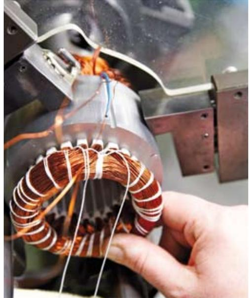
Für eine gute Stabilität sorgt die Bandagierung des Drahtes mit Nylonfäden
