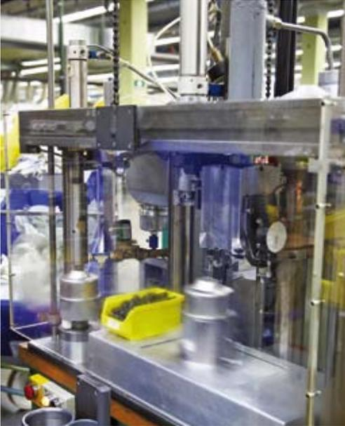
Die Ölkammer des Motors wird vollständig mit Öl befüllt – die Pumpe erhält dadurch einen Trockenlaufschutz
