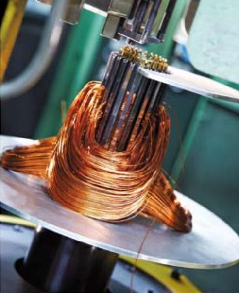
Die Entstehung einer U 3 KS beginnt mit dem Wickeln der Spulen für den Elektromotor
