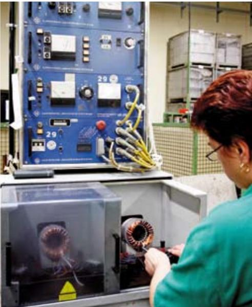
Es folgt der erste elektronische Test aller Leitungen und der Stromführungen
