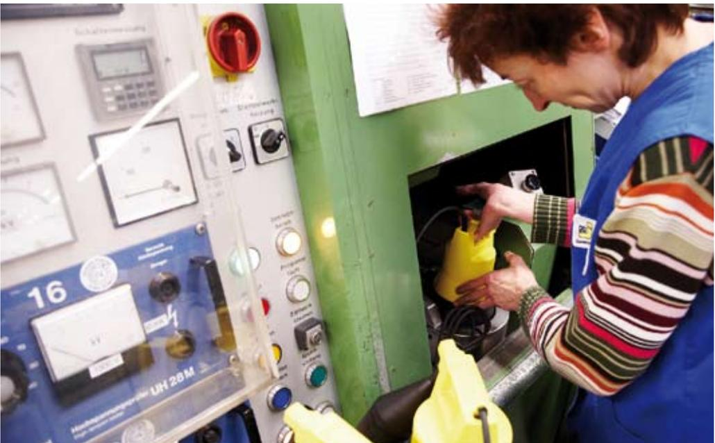
Abschließend werden alle Pumpenfunktionen getestet und die Pumpe mit einer Prüfnummer versehen
