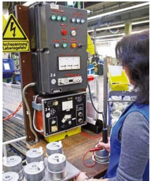
**Bei der Spannungsprüfung wird die Antriebseinheit auf Funktion getestet**
