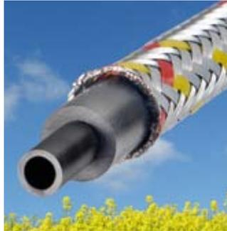
tierte Schlauchleitung besteht aus einer Innenschicht aus Spezial-Polyamid mit hoher Diffusionsdichtigkeit, aus einer Gummierung aus Chloropren-Kautschuk (flammwidrig, ozon- und lichterbeständig) und aus einem Drahtgeflecht als Druckträger und mechanischem Schutz. Lieferbar sind die Nenngrößen (NI) 4, 6,3 und 8. Zugelassen sind die Schlauchleitungen für den Einbau an Ölbrennern für den Vor- und Rücklauf. Neben Heizöl EL und L ist zudem der Betrieb mit Biodiesel (RME) möglich.
