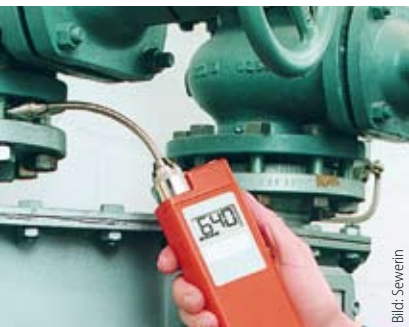
... Gas-Spürgeräte eingesetzt werden
