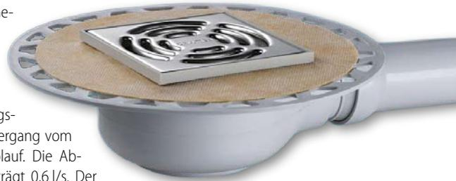
Geruchverschluss ist zur Reinigung herausnehmbar. Das Gehäuse hat einen variablen Ablaufstutzen DN 40/50 und kann durch das Kugelgelenk spannungsfrei angeschlossen werden. Zur Anpassung an das Fliesenbild stehen zwei Komplettabläufe mit Edelstahlrosten zur Verfügung: Kerdiplan K10 mit Rahmen 95 x 95 mm und Kerdiplan K12 mit der Rahmengröße 120 mm.
