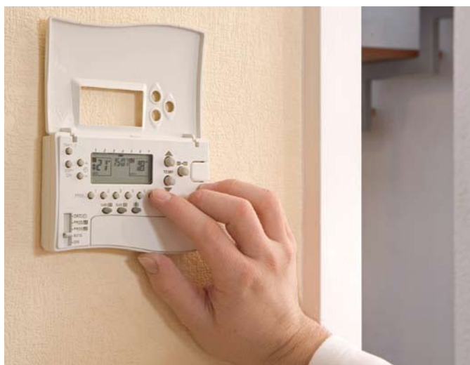
Drahtlose Datenübertragung: Die CM Zone Bedienzentrale kommuniziert über die Profifrequenz 868 MHz...
