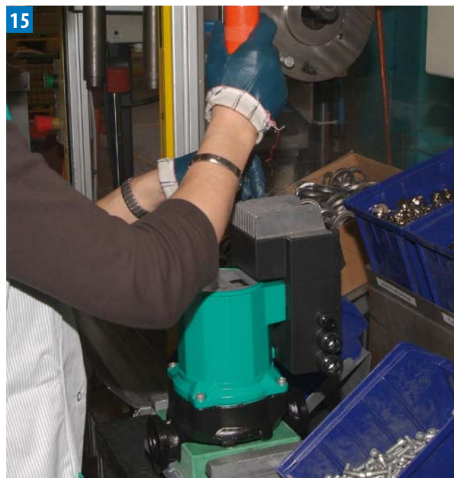
[14–15] Nach der Hochzeit wird das Elektronikmodul verschlossen und die Pumpe mit Dämmschalen versehen
