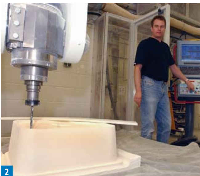
[1–3] Nach der Planungsphase wird ein Modell angefertigt, nach dem Modell entstehen die Formen und in diesen das künftige Sanitärobjekt
