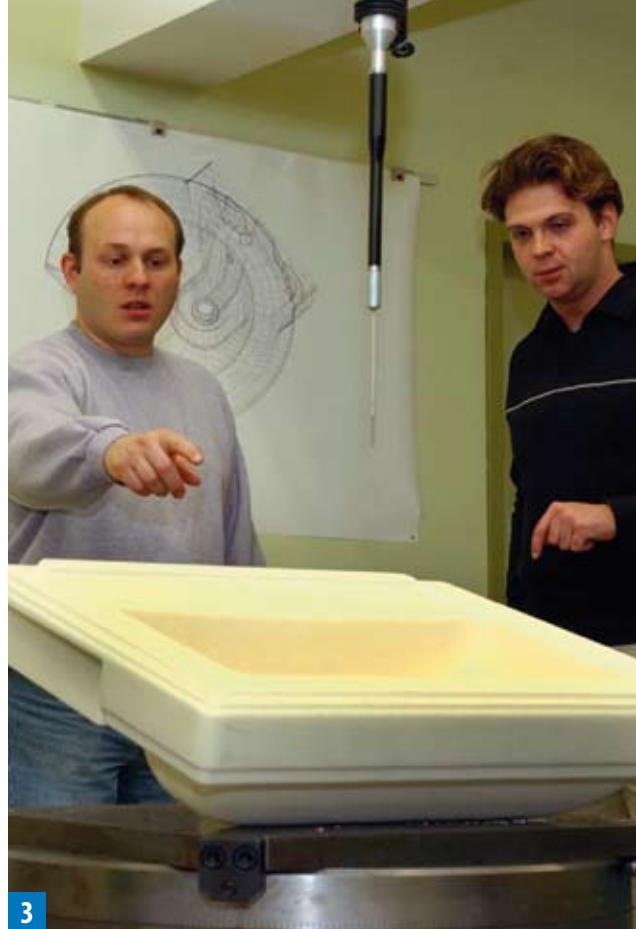
[1–3] Nach der Planungsphase wird ein Modell angefertigt, nach dem Modell entstehen die Formen und in diesen das künftige Sanitärobjekt
