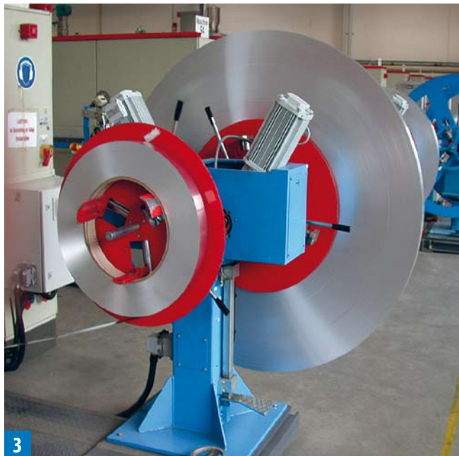
[2–3] Das Kunststoff-Granulat wird in Silos gelagert, das Aluminium wird als Band, aufgewickelt als Coil à 10 km Bandlänge, angeliefert
