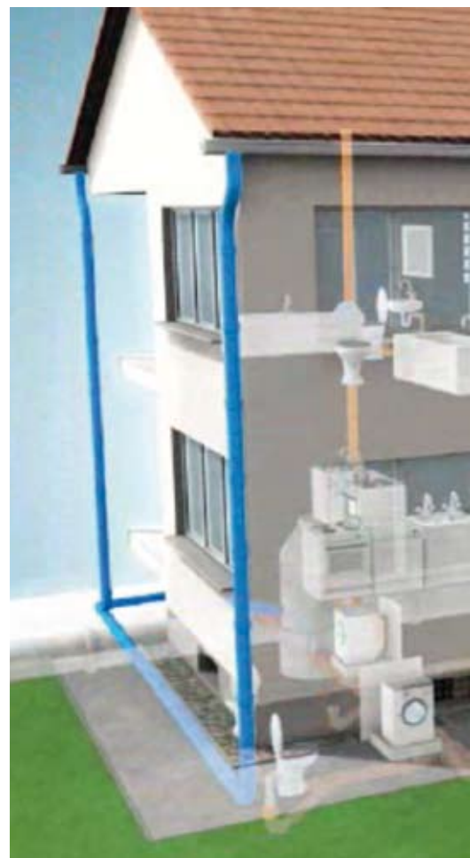
Die Grundleitungen des Haus-Entwässerungssystems
