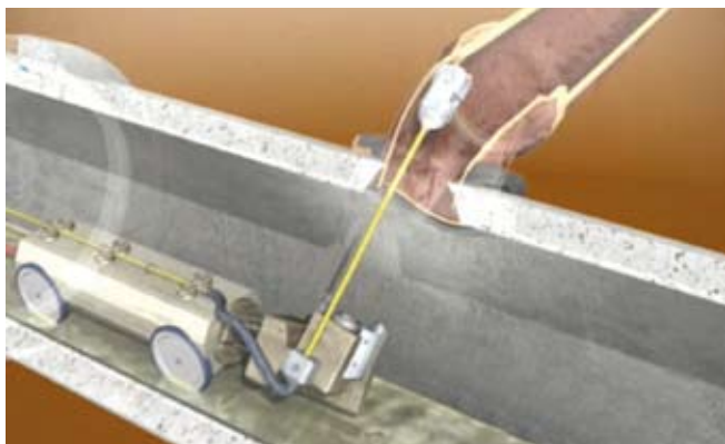
Eine Kanalkamera lässt solche Mängel erkennen – optische Mängelfreiheit muss aber nicht „dicht“ bedeuten
