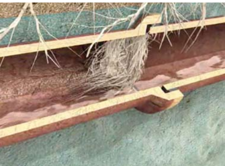
Grundleitungen sind häufig durch Wurzeln beschädigt ...
