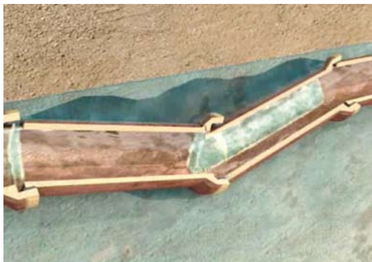
... oder durch Unterspülung abgeknickt
