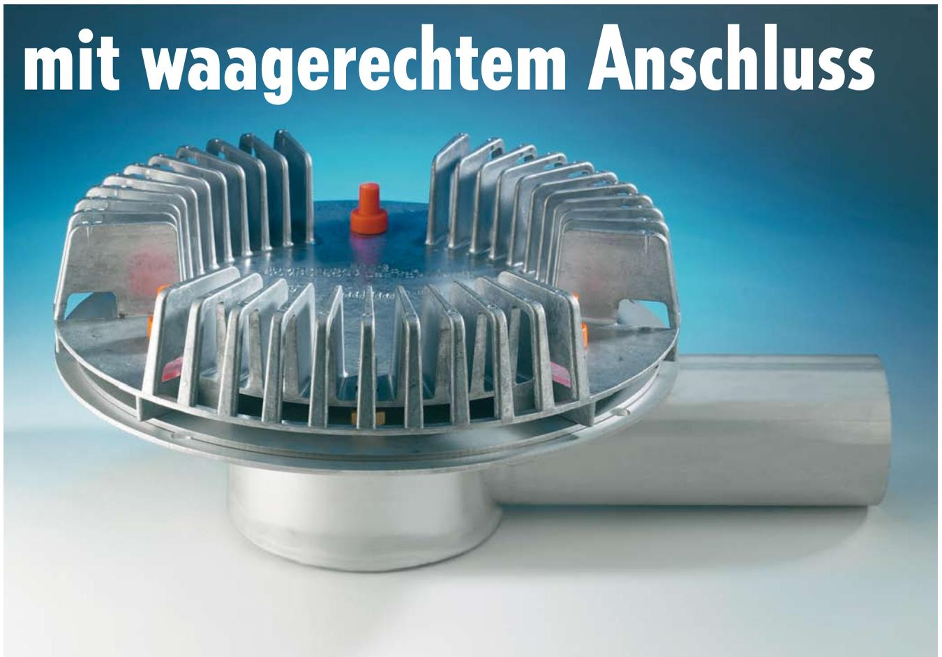
Sollen die Regenwasserleitungen aus optischen Gründen – oder weil es einfach an Platz mangelt – im Beton oder in der Dachdämmung verschwinden, ist der neue EPAMS-HDE-Flachdachablauf UNO 24 ein Problemlöser. Mit einer Aufbauhöhe von nur 95 mm beträgt die Ablaufleistung satte 8,0 l/s.
