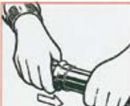
Pressverbinder unter leichtem Drehen bis zum Anschlag auf das Rohr schieben.
