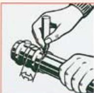
Einstecktiefe mit Filzstift markieren. **Wichtig:** Werden mehrere Stellen verpresst, kann sich das Rohr aus noch unverpressten Verbindungen etwas herausziehen. Hier muss vor der Verpressung nachgebessert werden!
