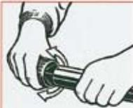
Rohr innen und außen entgraten. **Wichtig:** Grate können das Dichtelement beim Aufschieben auf das Rohr beschädigen!
