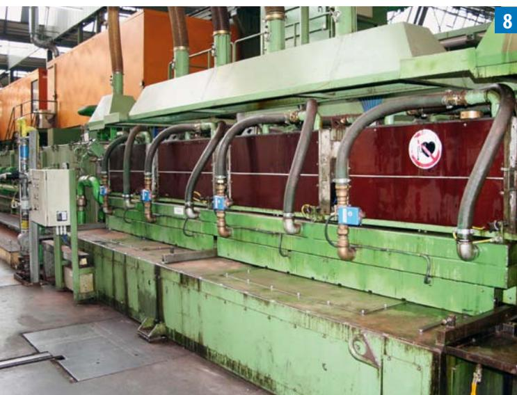
[8] Rohre, die in Ringen ausgeliefert werden sollen, durchlaufen eine Glühstation und werden wieder weich geglüht
