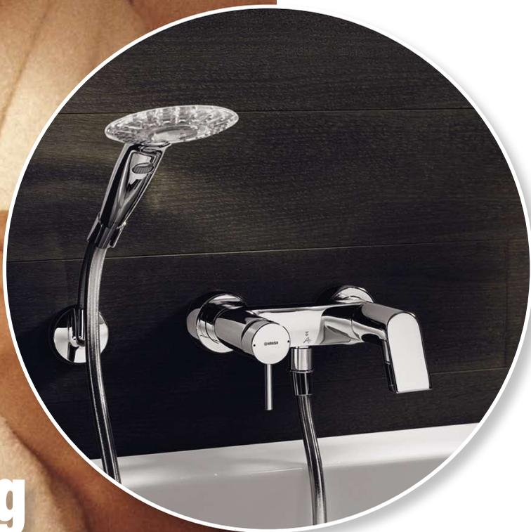
Hansastela von Hansa integriert die Umstellfunktion von Wanneneinlauf auf Brause in den Brauseschlauch – so bildet sie mit Brauseabgang und Schlauchanschluss eine konstruktive Einheit. Der Armaturenauslauf wird oben oder auf der Seite nicht mehr durch einen Umsteller unterbrochen und komplizierte Mechaniken für versteckte Umstellungen entfallen. Die Schlauchumstellung funktioniert mit jedem herkömmlichen Brauseschlauch.
